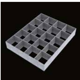
Riste med bære- og støttestål i samme dimension. Samme bæreevne i begge retninger.
